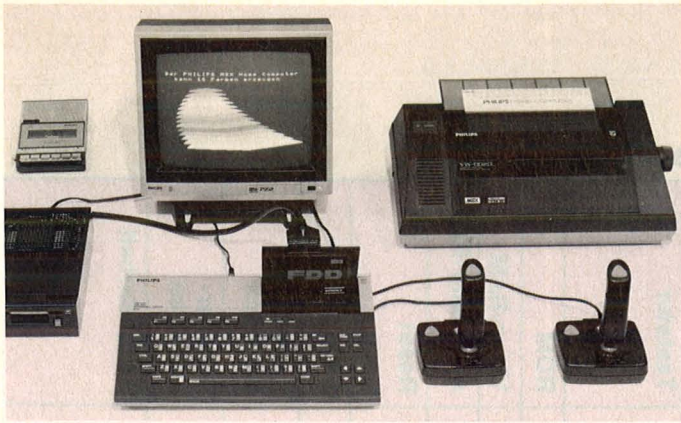
Die Philips-Anlage mit dem VW 0020-Drucker, der den vollen MSX-Zeichensatz nutzen kann
